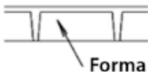
Seções transversais de lajes nervurada moldadas no local.
