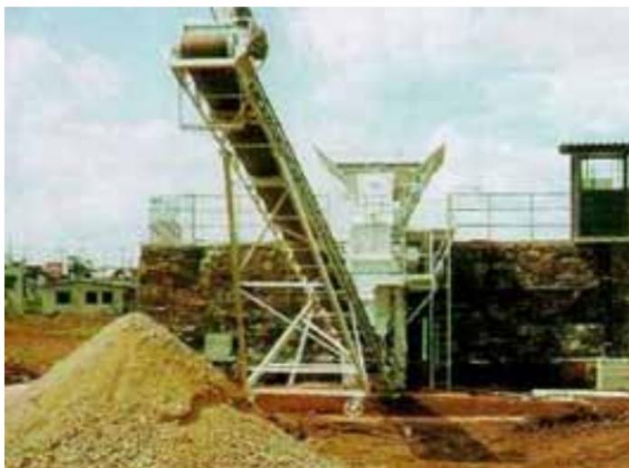
Figura 13 – Produção de agregados reciclados.
