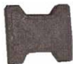
Figura 18 – Bloco de pavimentação com agregados reciclados.
